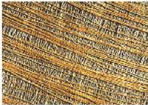
Fotografía al MEB de fibras de celulosa.
