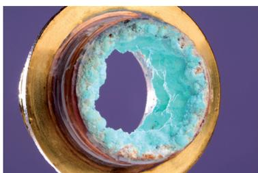
**Figura 3.16.** La cal es una sal poco soluble que forma incrustaciones como esta en el interior de un tubo de cobre (el color azul es debido al óxido de cobre).
