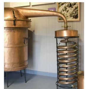
**Figura 3.25.** Esquema de una destilación y fotografía de un antiguo alambique (nombre de origen árabe que reciben estos aparatos).
