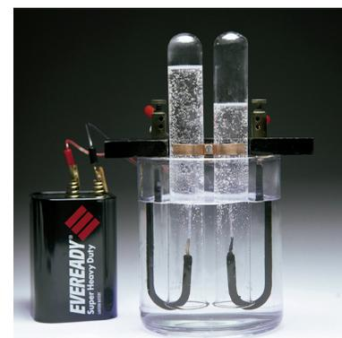
**Figura 3.8.** El agua, H<sub>2</sub>O, se descompone por la corriente eléctrica. Se obtiene el doble de hidrógeno, H<sub>2</sub>, que de oxígeno, O<sub>2</sub>.
