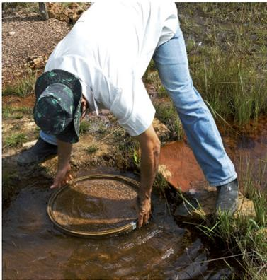
**Figura 3.20.** Los buscadores de oro en los ríos auríferos utilizan la técnica de la decantación con sus platos de búsqueda.
