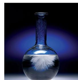
**Figura 3.26.** El cristal se forma a partir de partículas disueltas. La adición de un cristalito a la disolución saturada puede desencadenar la cristalización.
