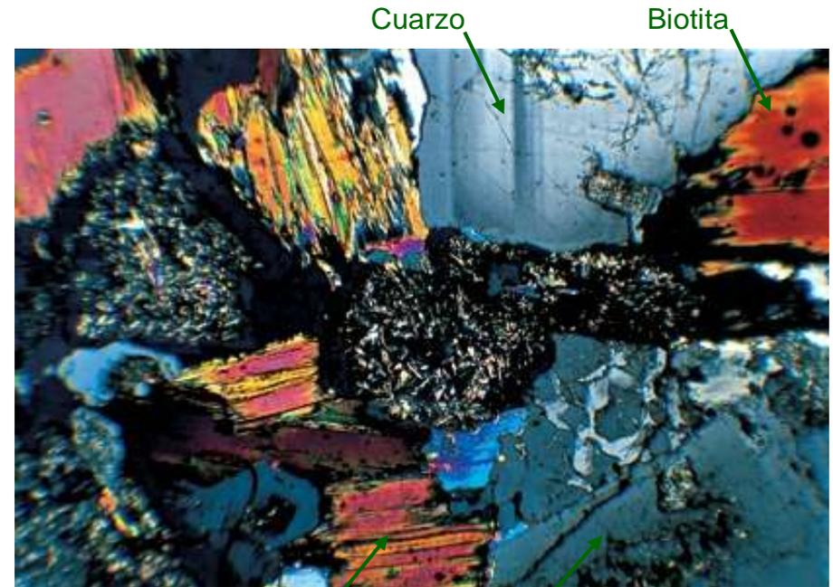
Granito al microscopio petrográfico.
